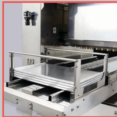
Tisch mit automatischem Zubringer Table with automatic trays feeder Стол с автоматической подачей противней
